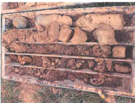
Figura 12.c: Stratificația întâlnită în forajul F3
