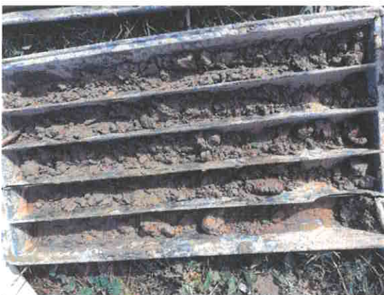
Figura 11.c: Stratificația întâlnită în forajul F2
